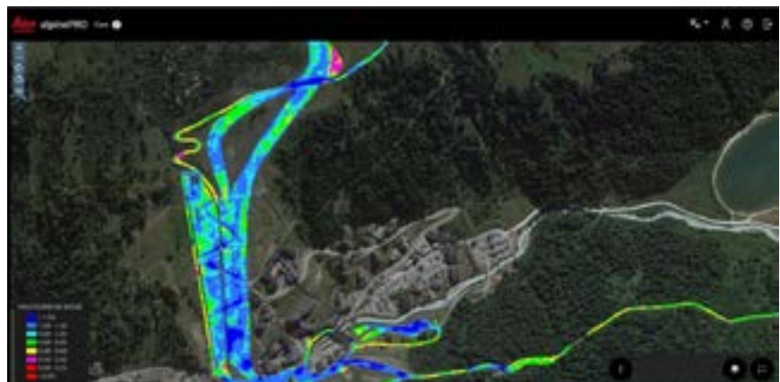
Visualisation des hauteurs de neige sur le logiciel Leica alpinePro Source: S3V
